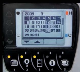
Sistema di registrazione delle operazioni
